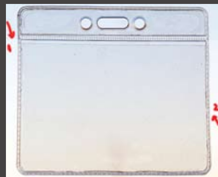
Pentru a obține contrast pe suprafețele transparente acestea se iluminează în principal din spate (contralumină). Acest tip de iluminare scoate la iveală conturul produsului.
